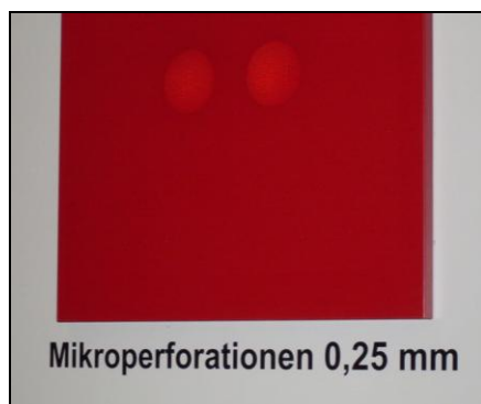
SNÍŽOVÁNÍ HLUČNOSTI. Panely z voštinových desek potažených lehkými textiliemi s mikro perforací pomáhají pohlcovat zvuk a snižovat hlučnost na pracovišti
