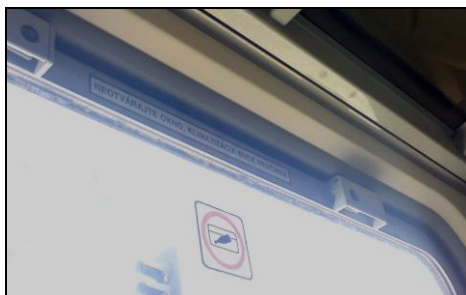
Nápisy o nefunkčnosti klimatizace po otevření okna stačí. Cestujícímu však musí být nezbytně ponechána možnost regulovatelného bezpečného otevření částí okénka.
