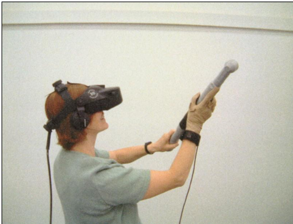
Obr.7a Obr.7b Obr.7c Využití nástrojů Virtuální reality pro ergonomické analýzy
