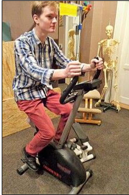
K testování výkonnosti v ergonomické laboratoři přispívá i ergometr, stroj podobný rotopedu, ke kterému se dále připojují kontrolní systémy dýchání. (Laboratoř designu Muzea umění a designu Benešov)
