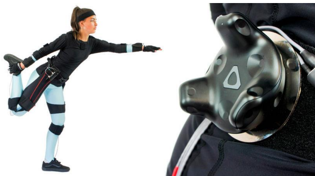
Obr. 8. Ukázka obleku pro hybridní snímání Synerial HTC VIVE/VICON (zdroj:synertial)
